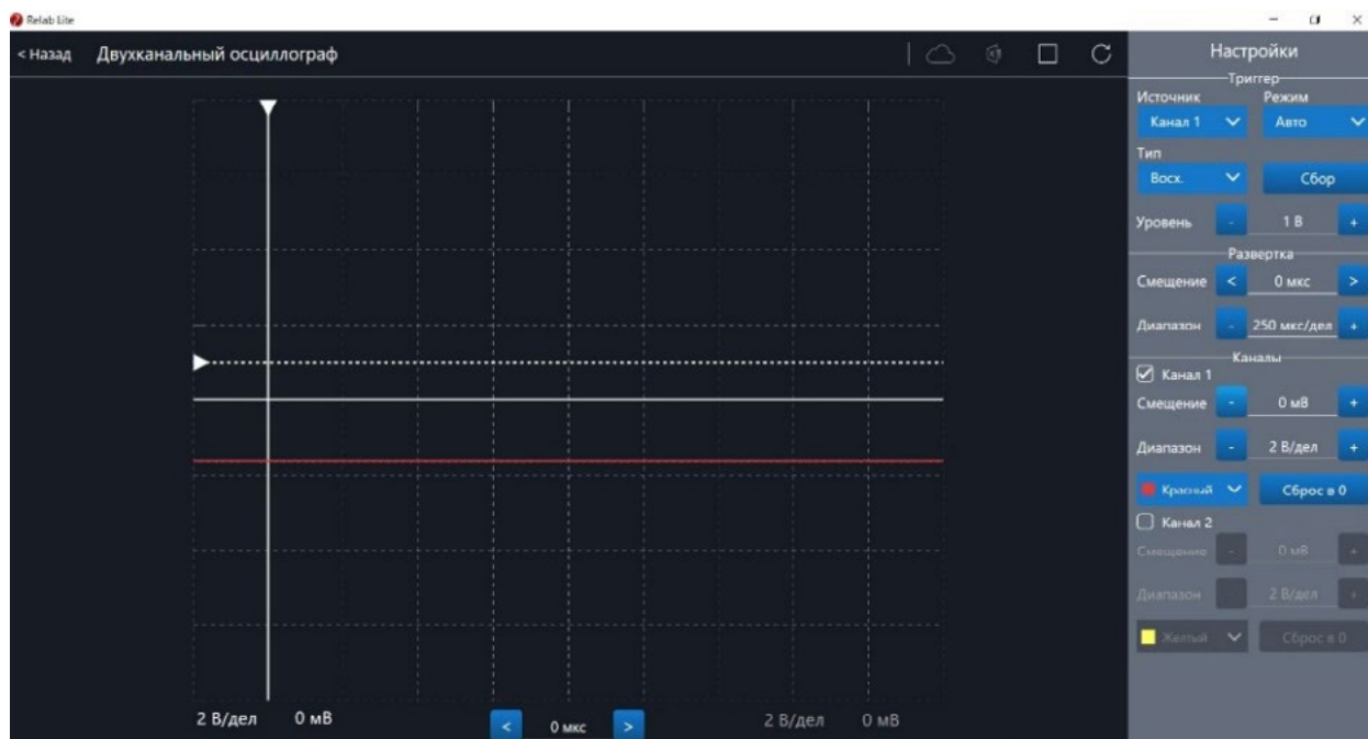
Рис. 40. Сигнал с ненулевым смещением
